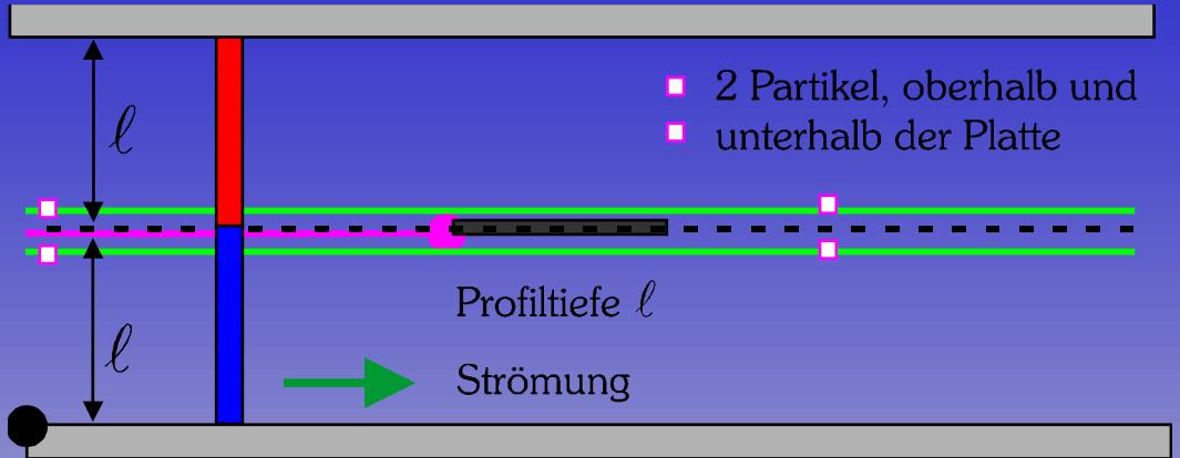
**Querschnitt durch Strömungskanal.**
