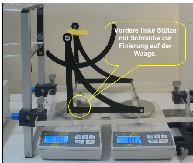
Support mit Messobjekt und Lagerschalen mit Stützen zur Fixierung an den Waagen.
