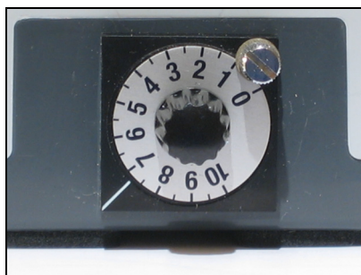
Einstellen für den Abgleich der Empfindlichkeit
