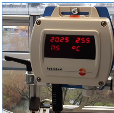
Display of the windsensor („ns“ stands for „m/s“)
