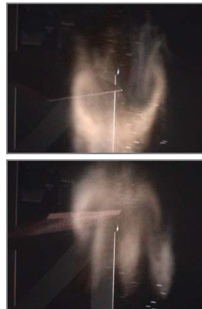
Abb. 14: Randwirbel bei Auftrieb und Abtrieb.
