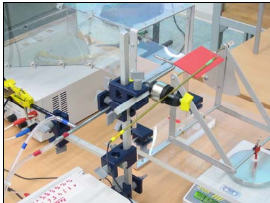
Abb. 3: Messtisch für eine Tragfläche (rot).
