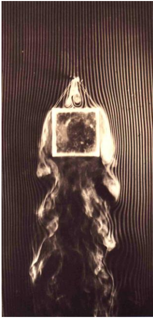
Abb. 3: Umströmung eines quadratischen Hindernisses. Stromlinien in einem Rauchkanal von É.-J. Marey in [7]. Die Aufnahme ist um 1900 entstanden.
